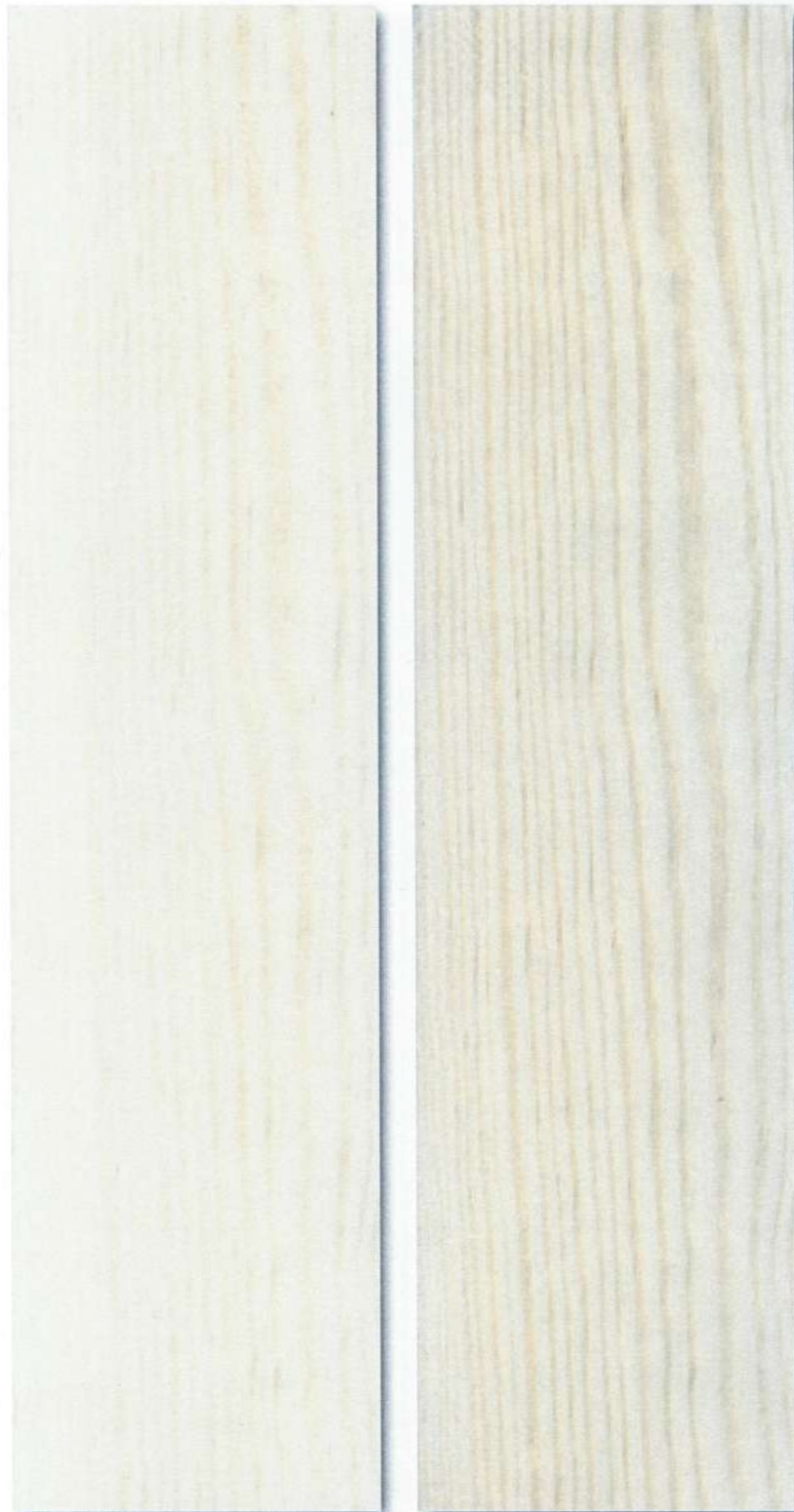
Abbildung 2: Probe 2 - Kiefer mit KaWaTech HMS9 beschichtet - unbewittert (links), nach 1 Jahr Freilandbewitterung (rechts)
