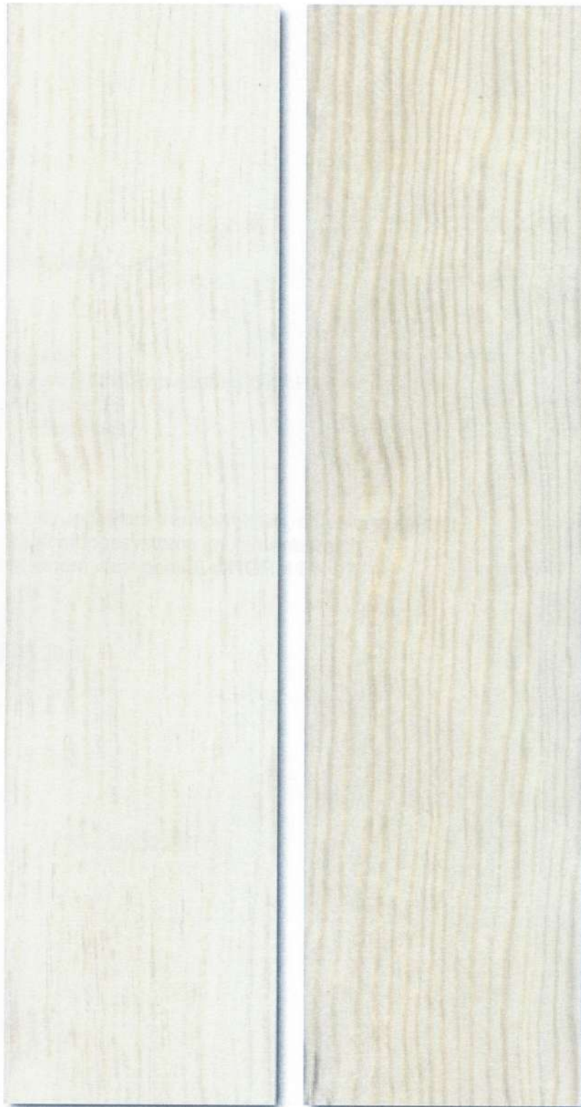
Abbildung 3: Probe 3 - Kiefer mit KaWaTech HMS9 beschichtet - unbewittert (links), nach 1 Jahr Freilandbewitterung (rechts)
